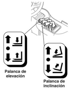
Tirar la palanca de elevación hacia atrás para elevar las horquillas de 152 a 203 mm (6 a 8 pulg) sobre el suelo.
