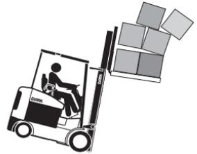
El vuelco lateral y longitudinal puede producirse si el montacargas se conduce por encima de objetos en el suelo, sobre el borde de una superficie pavimentada y sobre baches, o como resultado de chocar contra algún objeto elevado o sobre el suelo.
