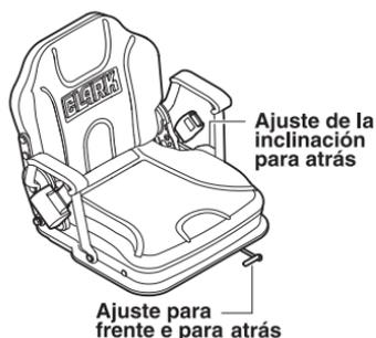
Empuje la palanca para arriba y ajústelo para atrás, y suelte la palanca. Verifique si el mecanismo de travamiento para atrás está realmente travado.
