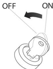
La llave de contacto siempre debe ponerse en la posición de marcha para manejar el montacargas. Cuando la llave está en la posición vertical de apagado, los instrumentos y los circuitos eléctricos de mando y del motor de la bomba se desconectan (apagan) y la llave puede sacarse. La bocina debe funcionar en todo momento, siempre y cuando una batería debidamente cargada esté conectada al receptáculo del montacargas.
