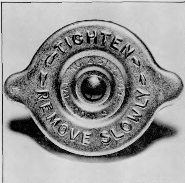
Plate 6458. Radiator Pressure Cap (7#)
